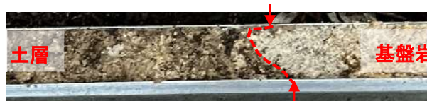
図2 流紋岩質凝灰岩における土層境界の判定例
