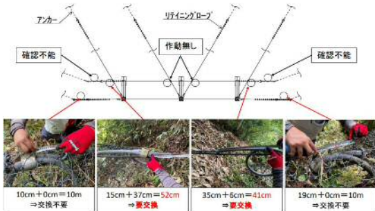
図-3 緩衝装置作動状況
