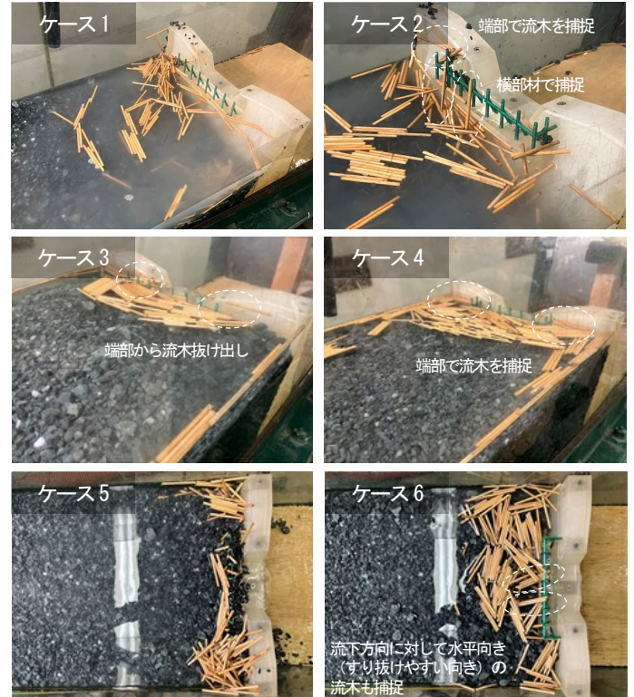
図-4 流木捕捉状況（一例）
