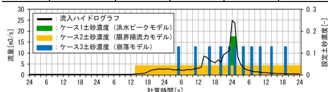
図-3 扇状地区間のハイドログラフと設定土砂濃度
