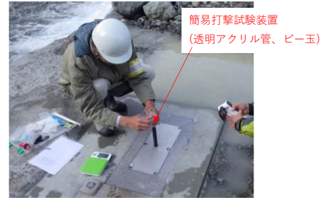
図-5 ハイドロフォンの簡易打撃試験
