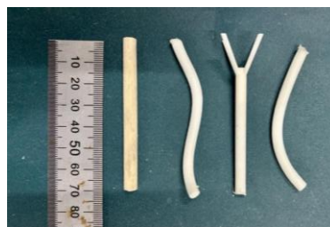
図3 流木模型の形状(円柱・S字・根付き・弓型)
