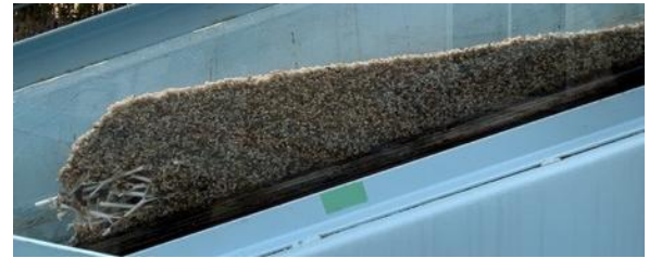
図3 根付き流木による流木塊の形成・閉塞状況
