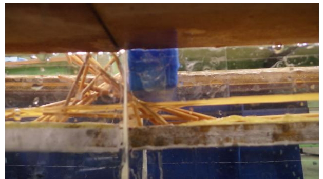
図-2(b) 橋梁模型地点での閉塞状況 (CASE2)
