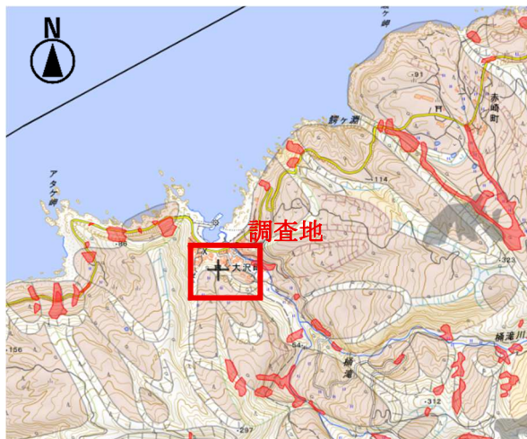
図1 地形図(地すべり地形分布、地震後、豪雨後の崩壊地(赤ハッチング箇所))
