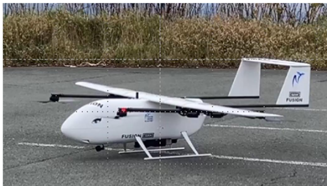
写真-1 LiDAR を装着した VTOL 型固定翼 UAV
