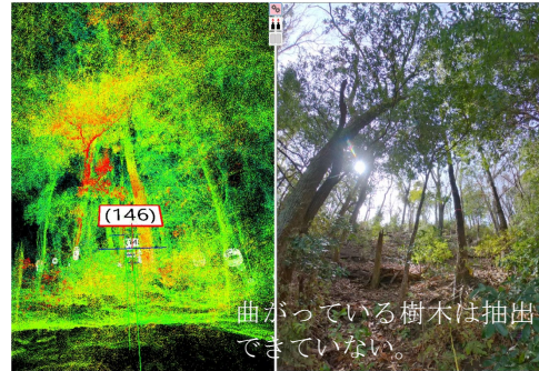
図8 地上レーザ測量による計測事例
