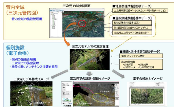
図1 施設点検データプラットフォームの機能概要
