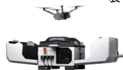
図2 使用したドローンポートの外観 (自動離着陸・機体充電・遠隔通信・ポート間連携機能を使用)
