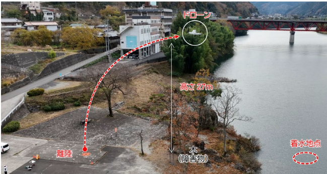
図2 水空合体ドローンの飛行状況
