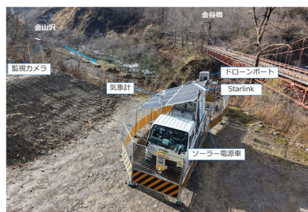
図2 離発着地点における電源・通信機器等設置状況
