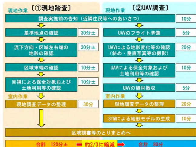
図2 現地踏査とUAV調査の作業手順と作業時間の比較
