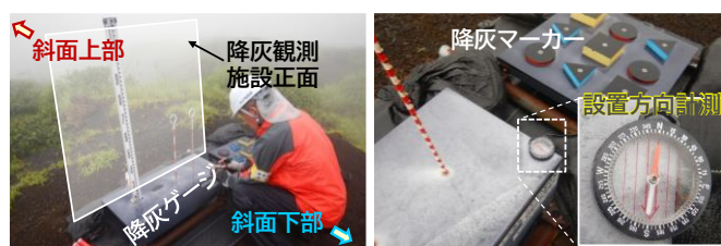
図3 降灰観測施設の設置方向の計測状況
