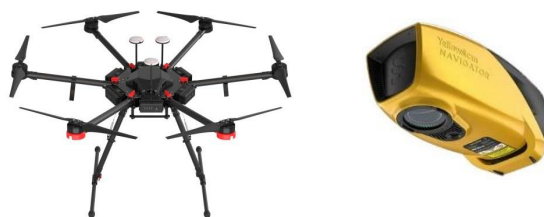
図 2 使用機材（左：Matrice600 Pro、右：YellowScan Navigator）
