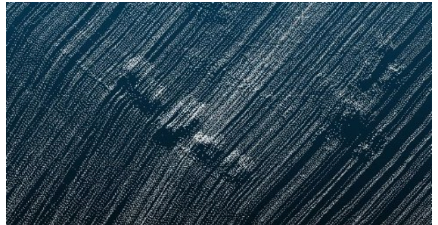
図6 ダミー変状計測結果の拡大(単コース、高密度)
