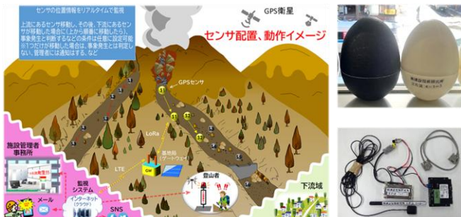
図 1 土砂移動検知イメージ (左)、試験に使用した機材 (右)
