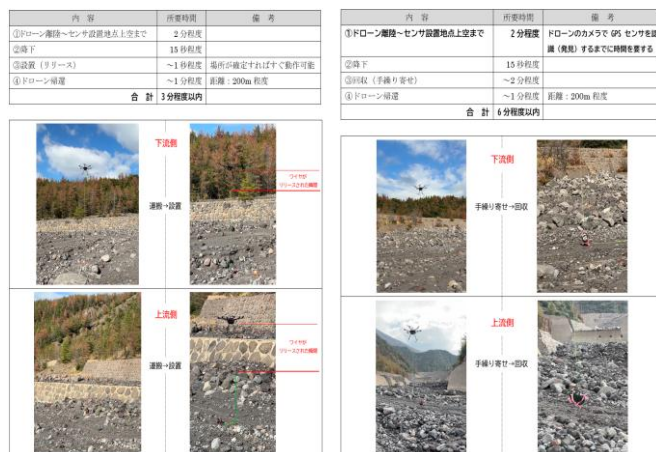
図 3 UAV での運搬設置、回収状況
