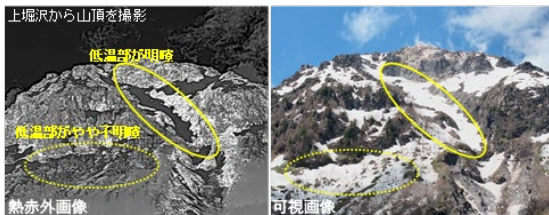
図5 熱赤外の遠望撮影例：黒色部が低温域
