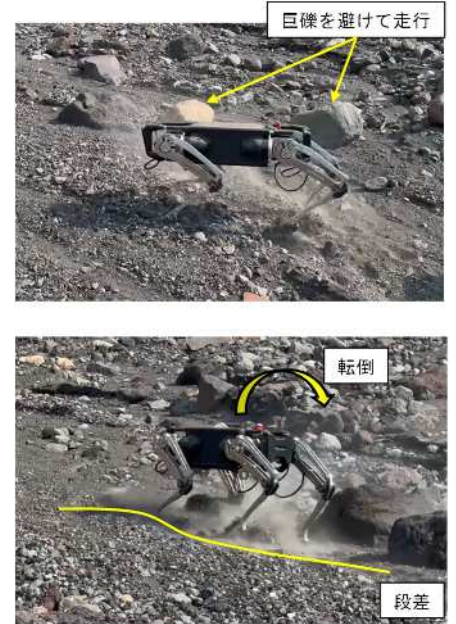
図-5 河床部での走行状況
