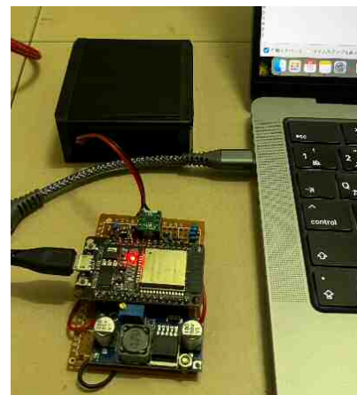
図-2 検出器 (上:シンチレータ, 下:マイコン)
