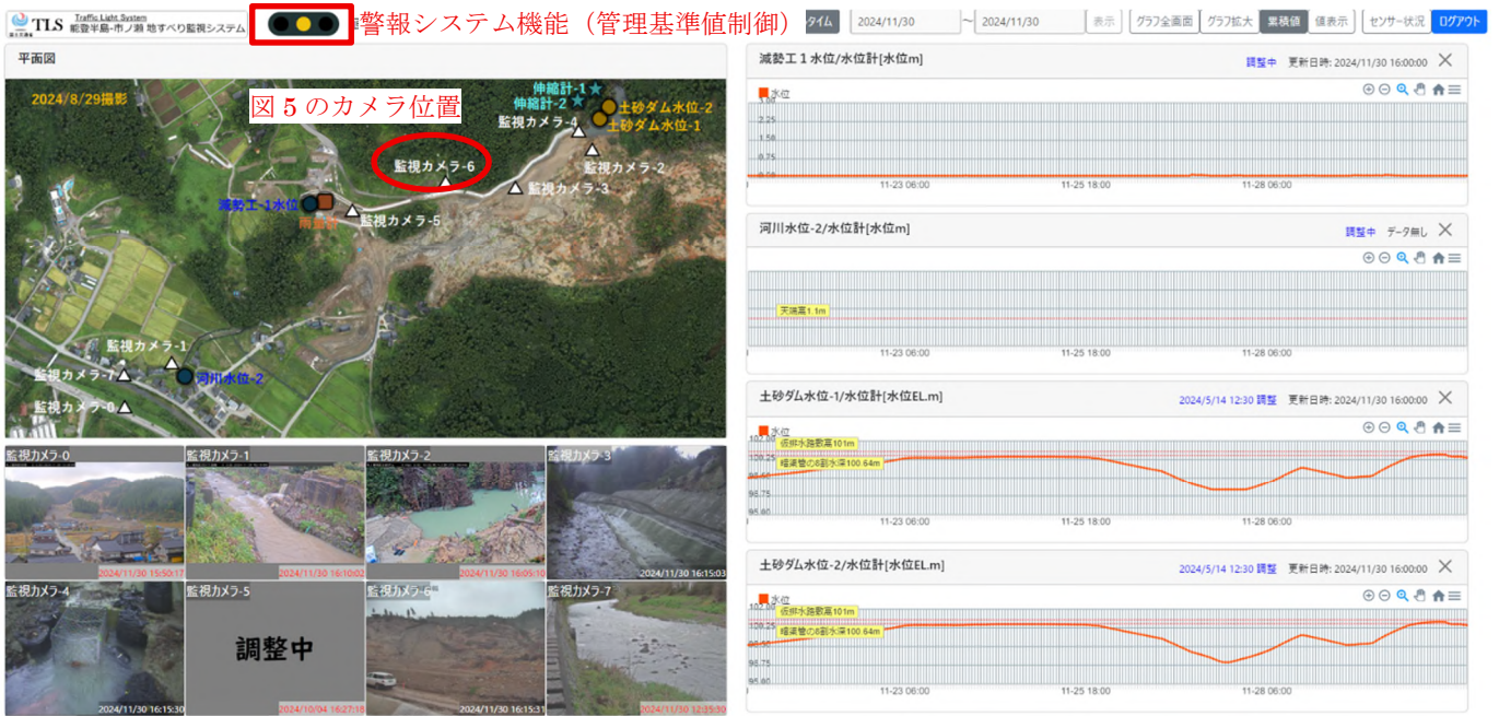
図3 輪島市市ノ瀬町での統合型土砂災害監視システム (TLS) の画面構成
