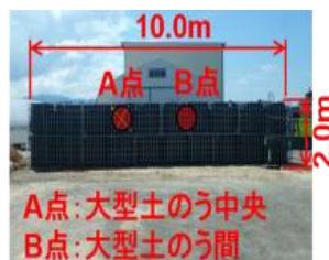
図3 応急土石流ガード衝突点
