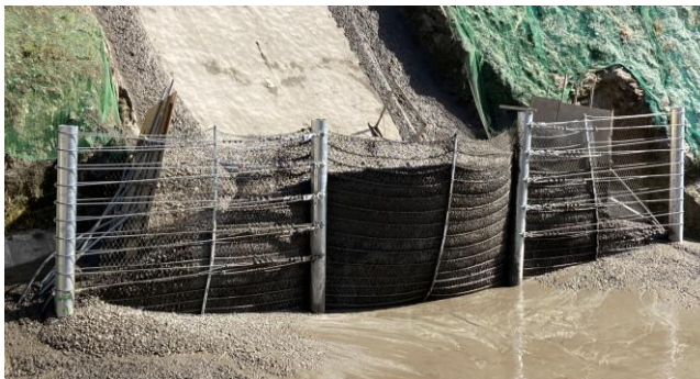
図-3.3 土砂衝突後の実験柵状況
