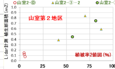
図-7 LiDaによる植生計測結果と植被率の対比
