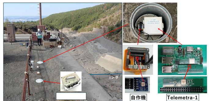
図-1 振動センサ設置状況
