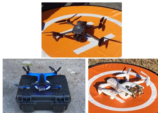
図1 実証試験に使用した機体（上：MAVIC 3 Enterprise，左下：Skydio 2+，右下：ANAFI Ai）
