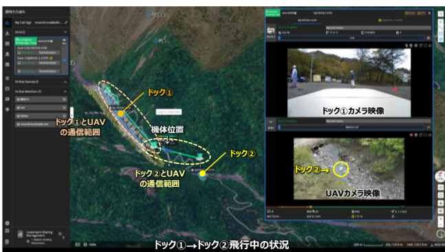
図-5 飛行ルート及び飛行状況（ケース②）
