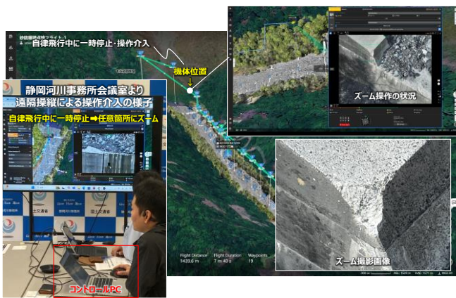
図-4 遠隔操縦（一時停止・ズーム撮影）の様子
