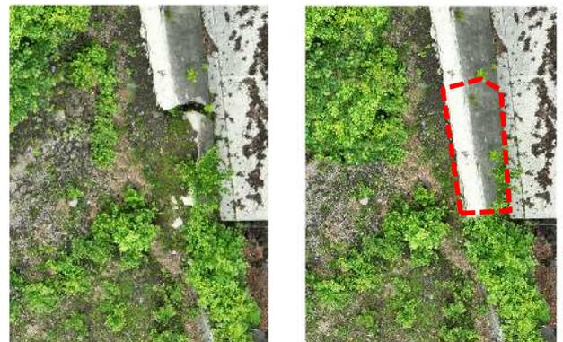
図-2 変状のある設備の元の画像(左)と元の設備の形状を模した画像赤の破線は復旧した範囲(右)の例
