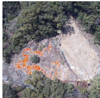
図-5 熱赤外線調査結果 ：空洞部(白)もしくは土砂化部と想定される範囲(赤～橙)
