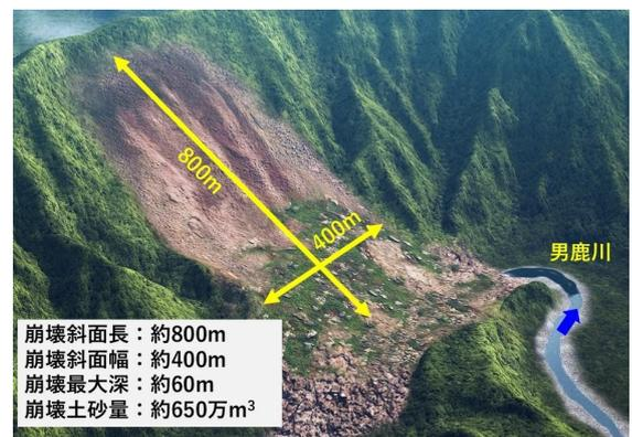
図-2 大規模崩発生時の崩土堆積イメージ図
