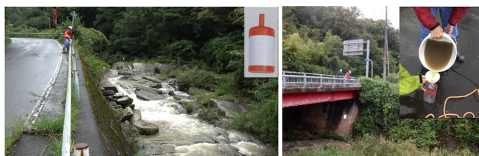
図2 左: 浮子法実施状況 右: バケツ採水実施状況
