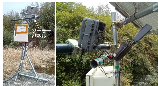
図4 インターバルカメラ設置状況
