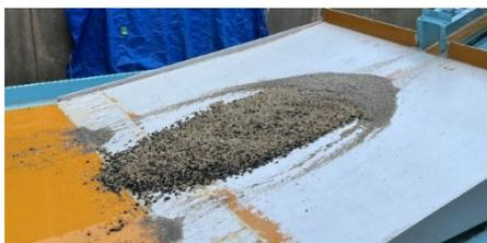
図5 15m水路の氾濫台での堆積状況の一例
