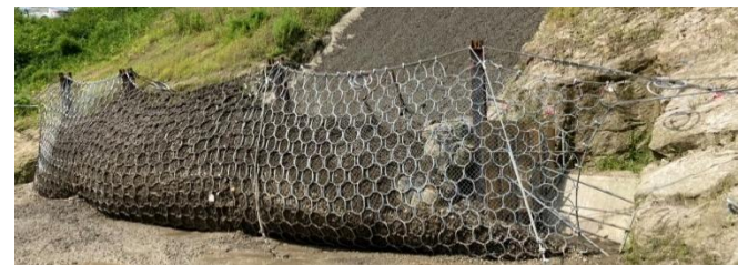
図－4.3 土砂衝突後の実験柵状況
