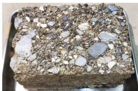
図1 硬化後のCAE 路盤材
