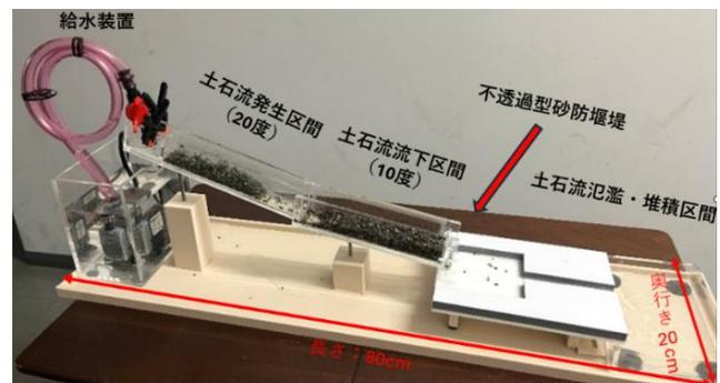
図-1 新規製作した小型土砂水理模型
