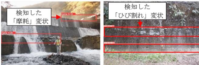
図-5 変状検知機能による検知例
