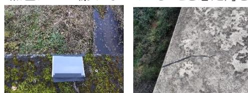
図-3 疑似変状(左:摩耗,右:ひび割れ)
