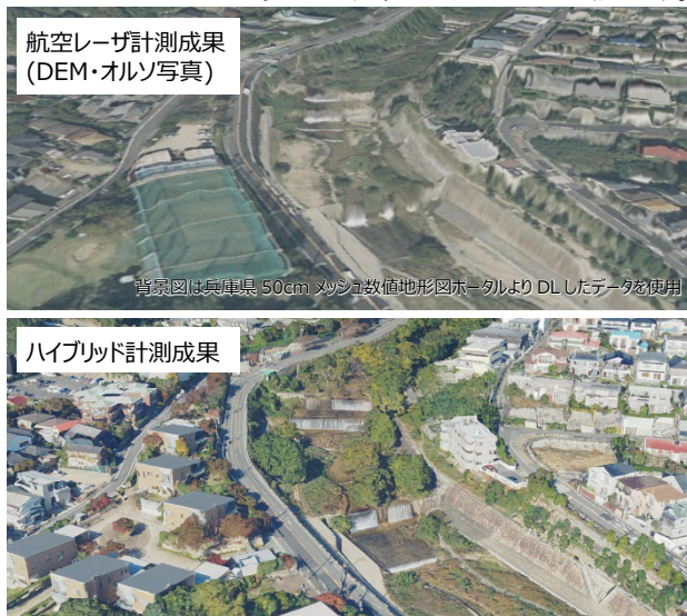
図 5 航空レーザ計測成果との比較例
