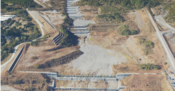
図 4 床固工群 3D モデルの例
