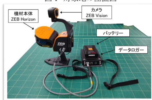
図 2 ZEB Horizon + ZEB Vision の外観 表 1 基本性能
