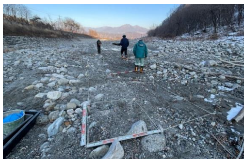
図1 河床材料調査 面格子法の様子
