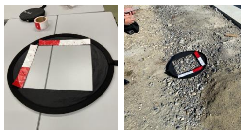
図2 折りたたみ式スケール(開発中)
