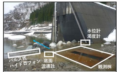
図-2 流砂観測設備の基本構成
