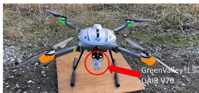
図-2 上段：VTOL 固定翼 UAV、下段：マルチコプター UAV（両機体共、LiDAR 装備）
