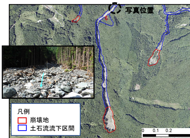
図-3 崩壊地及び土石流流下区間
