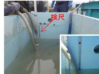
図-4 検尺による水量管理
