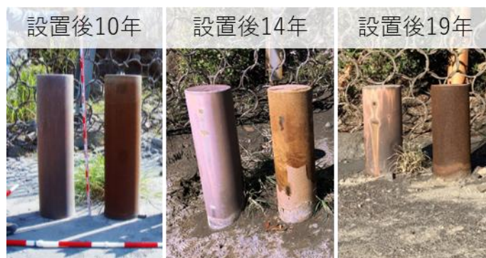
図2 暴露供試体設置状況
