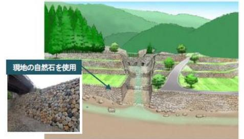
図-3 A ランクの砂防堰堤イメージ
