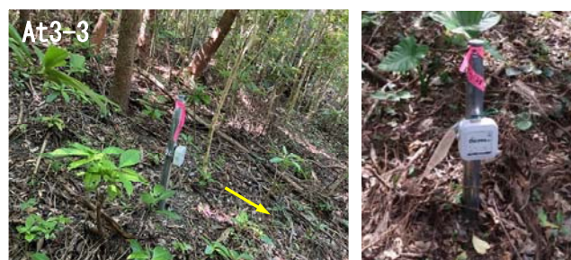
図-5 地表傾斜計の設置状況
