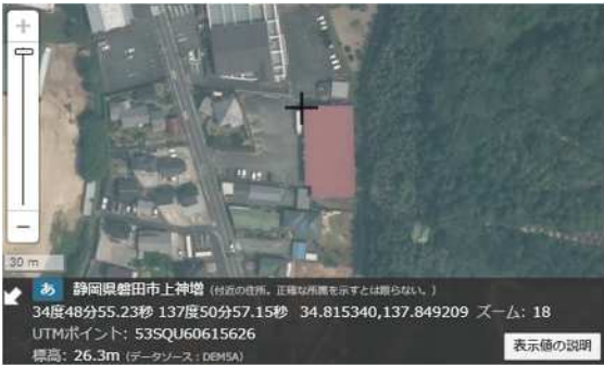
図-1 地理院地図での代替 GCP の取得例 代替 GCP として人家軒先を指定(標高：26.3m)
